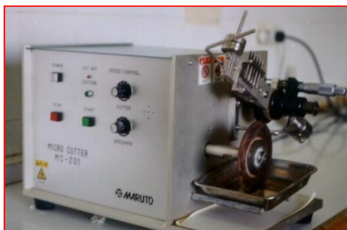
شکل ۱. دستگاه برش بافت سخت (Micro-catter) برای برش سنگ‌گوش‌ها
