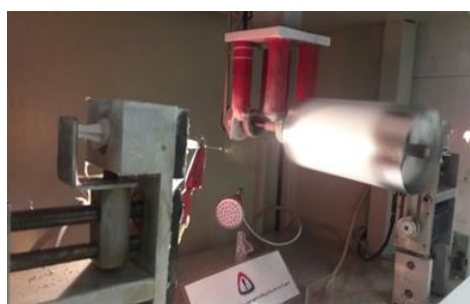
شکل ۵. دستگاه الکتروریسی در حال پرتاب غشا PLGA روی فایل آلومینیومی
